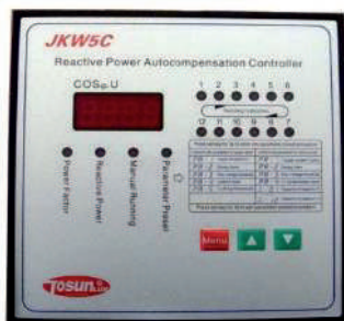
Relais varmétrique JKW5C
